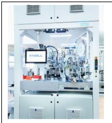
**BU: Auf 1,6 m x 1,6 m ist in der neuen, kompakten Anlage von Knoll Feinmechanik alles untergebracht, was zur Montage marktüblicher Einweg-Schlauchsets nötig ist.**
