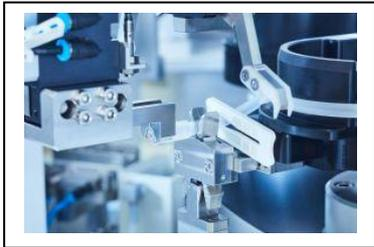
***BU: Montage von medizinischen Einweg-Schlauchsets mit der Lösung von Knoll Automation: Eine Klemme ist schon aufgeschoben, ein Luer-lock-Endstück wird gerade montiert.***
