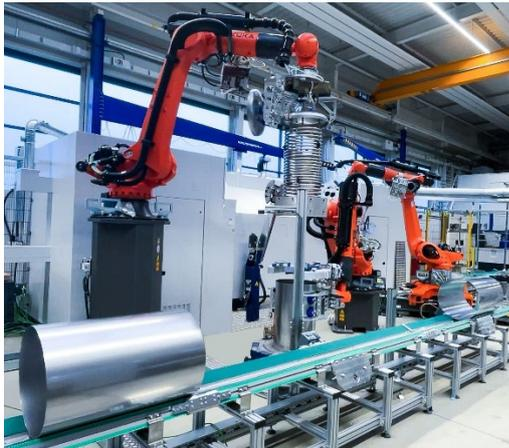
Mit unseren vollautomatisierten Schweißprozesslösungen werden hochwertige Druckbehälter wie Edelstahlboiler mit Wärmetauscher, Wasserspeicher aus Edelstahl oder Schwarzblech genauso wie Rohre von dünnwandig bis zu Wandstärken von 3,5 mm effizient produziert.
