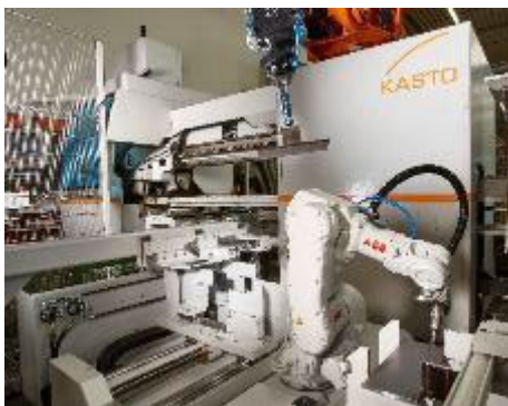
Bild 3: Die Entnahme der Sägeabschnitte und zahlreiche weitere Aufgaben von Entgraten und Anfasen über Zentrieren und Gewindeschneiden, Markieren und Bedrucken bis hin zum Sortieren, Abstapeln und Kommissionieren können mit der Roboter-Anbindung KASTOsor automatisiert werden.
