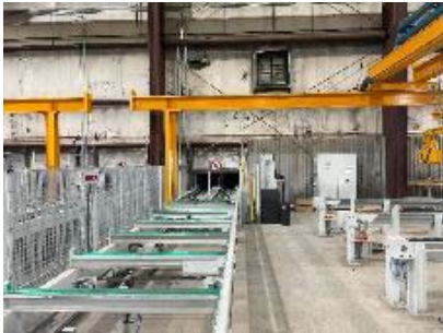
Bild 2: Stahlprofile werden über die Umlaufstation schnell und sicher ins Lagersystem übergeben – für einen effizienten Materialfluss.
