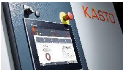
Bild 1: Das neue Dashboard der KASTO-Sägesteuerung stellt Maschinenzustände, Aufträge sowie Lauf- und Stillstandszeiten übersichtlich dar.
