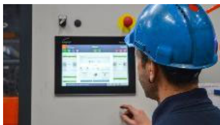
Bild 6: Die neue Steuerung erlaubt den komfortablen Wechsel zwischen Ansichten und Funktionen auch während eines laufenden Sägevorgangs.
