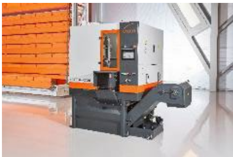
Bild 1: Der elektromechanische Sägevorschub der KASTOssb AC 2.6 nimmt nur dann Leistung auf, wenn tatsächlich gesägt wird. Anwender profitieren von geringerem Energieverbrauch und reduzierten Geräuschemissionen.
