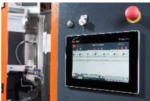
Bild 2: Die neue Steuerungsgeneration ProControl unterstützt den parallelen Zugriff auf verschiedene Bedien- und Informationsansichten während des laufenden Sägevorgangs.
