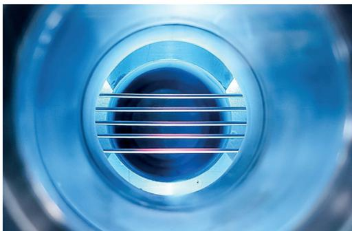
**In einem Mikrowellenplasma wird CO<sub>2</sub> in O<sub>2</sub> und CO gespalten. Das O<sub>2</sub> kann über eine Hohlfasermembran abgetrennt werden. Das CO kann dann mit grünem H<sub>2</sub> zu werthaltigen Produkten umgesetzt werden. © Fraunhofer IGB**
