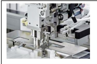
**BU: Den Handling-Head von Knoll Feinmechanik gibt es in unterschiedlichen Ausführungen; am abgebildeten Fügeprozess beteiligt sind gut sichtbar ein Zentrier- und ein Montagegreifer.**
