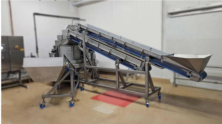
Das K650 Trocknungssystem ist eine vollautomatische, kontinuierlich arbeitende Anlage zum Trocknen von geschnittenem Salat und ganzen Blättern sowie von geschnittenem Gemüse und Obst.
