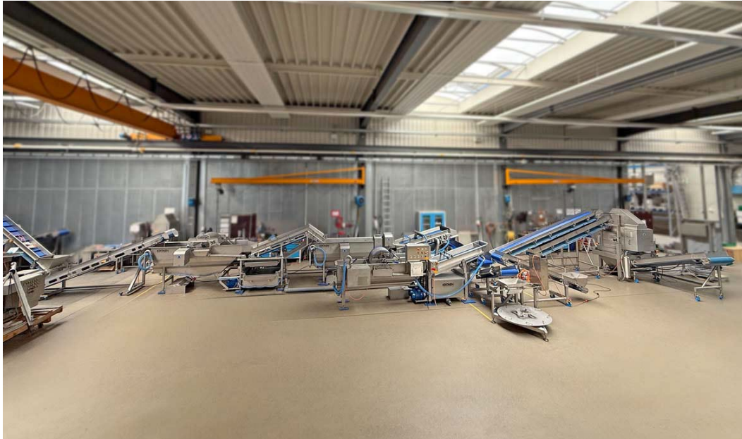
Die neue Linie verarbeitet Blattsalate zu küchenfertigen Mischsalaten. Täglich werden mit dieser Linie bis zu sieben Tonnen Salat verarbeitet.
